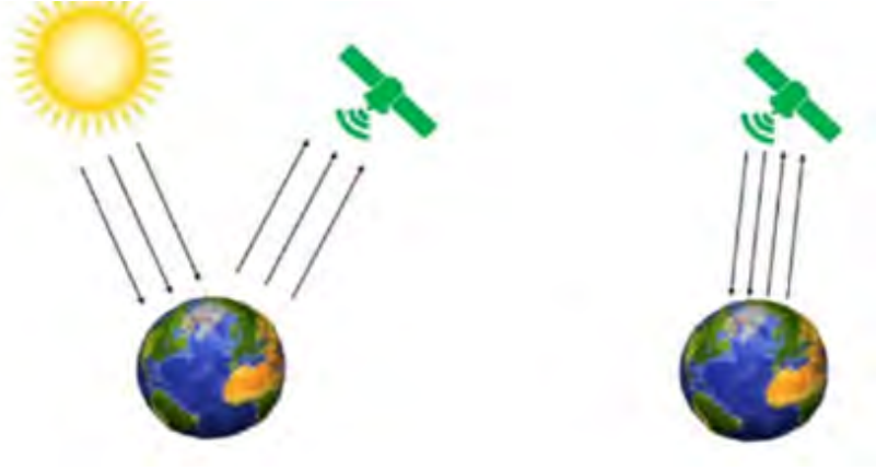
Resim 1. Uzaktan Algılama Sistemleri A. Aktif Sistemler B. Pasif Sistemler (Singh ve Singh, 2024)
