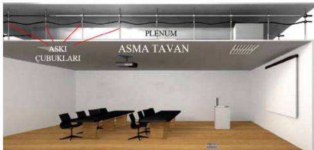
Şekil 1. Asma tavan sistemlerinin şematik yapısı (URL-1)
