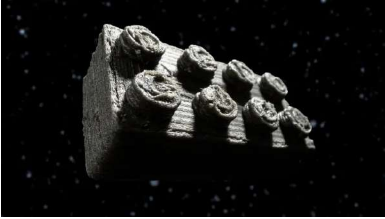
Şekil 16. “ESA Uzay Tuğlaları”, ay yüzeyinde inşaat için uygunluklarını test etmek amacıyla göktaşı, polilaktid ve regoliti taklit eden malzeme karışımı kullanılarak 3B yazıcıyla üretilmiştir. (Pearlman, 2024)
