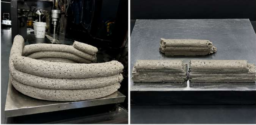
Şekil 2. Regolit paketleri üretim süreci (Bodiford vd., 2006)
