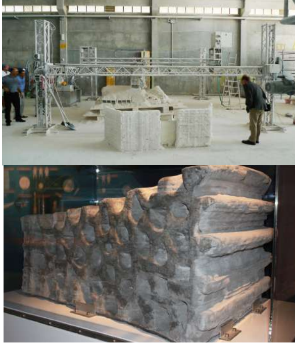
Şekil 5. Ay yerleşkesinin dış kabuk segmenti, magnezyum klorür bağlayıcı ve Ay regoliti benzeri malzeme kullanılarak eklemeli imalat yöntemiyle üretilmiştir (Ramiccio, 2022).
