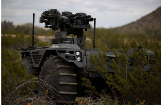
Şekil 2. Rheinmetall PATH A-Kit, araç üzerindeki LIDAR, radar ve kamera verilerini birleştirilmesi
