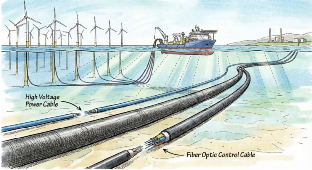
Şekil 1. Su altı enerji ve veri transfer hatları
