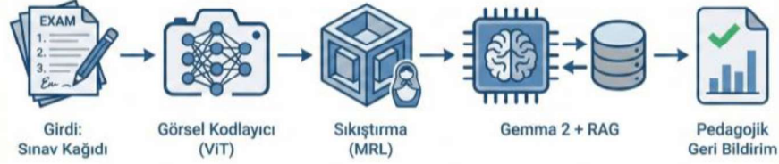
Şekil 1. Önerilen mobil öncelikli ve çok modlu sistemin veri akış mimarisi. Görsel veri ViT ile işlenip MRL ile sıkıştırıldıktan sonra, Gemma 2 modeli RAG modülünden aldığı bağlam desteği ile nihai geri bildirimi üretir.
