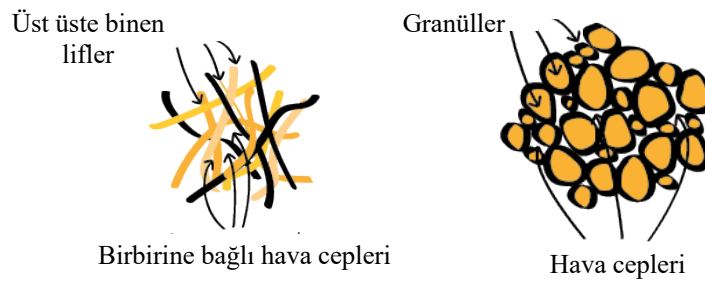
Şekil 6. Lifli Yutucular ve Granüler Yutucular [12]
