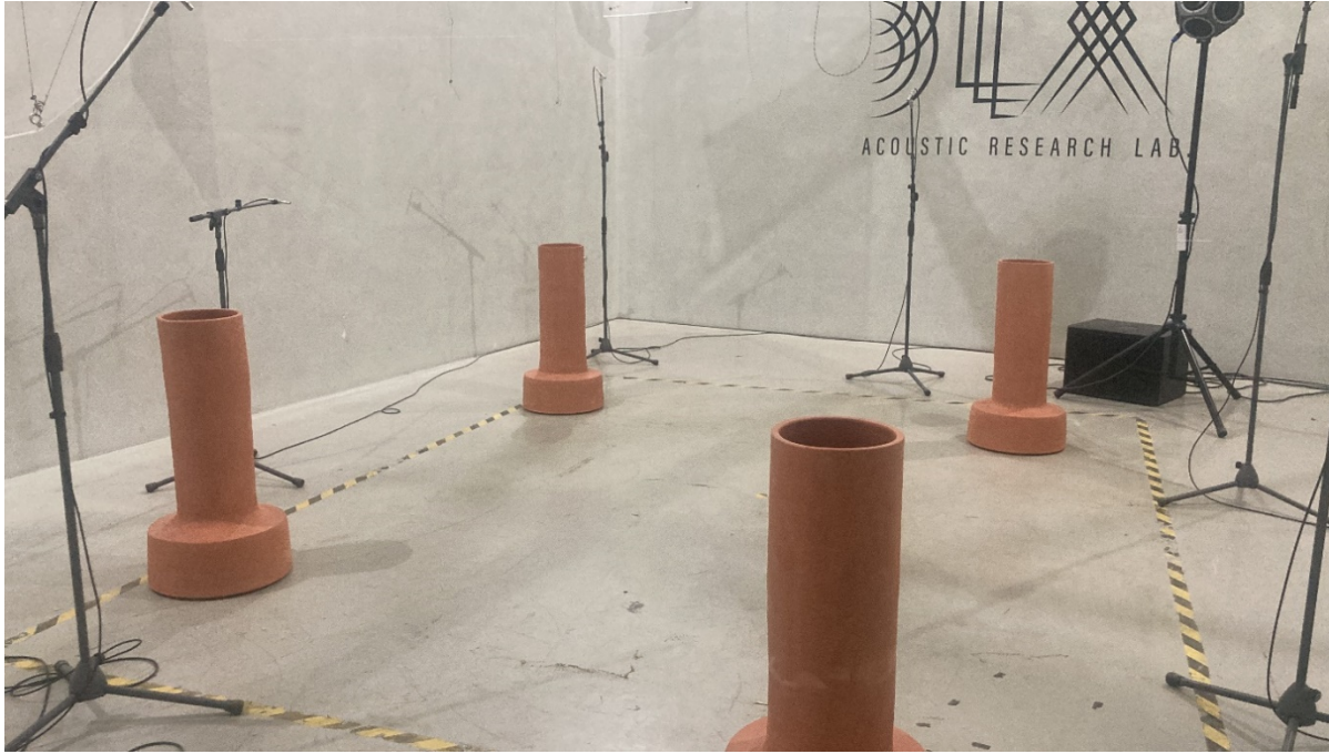
Şekil 7. Çınlama odası içerisinde ölçüm süreci
