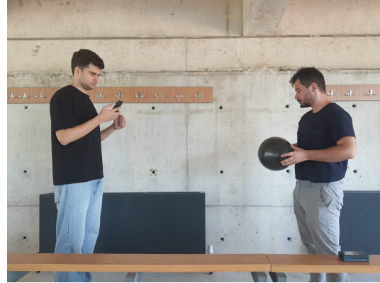
Şekil 1. RT-60 Reverberasyon süresi ölçümü Şekil 2. RT-60 Reverberasyon süresi ölçümü-2
