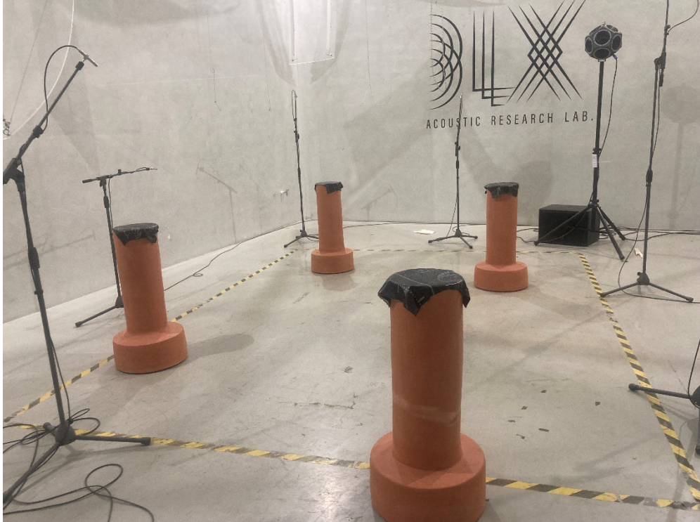
Şekil 6. Rezonatör boyun girişinin membran kullanılarak kapatılması ile etkili emicilik frekansındaki değişiklikler ve performans farklılıkları gözlemlenmeye çalışıldı.
