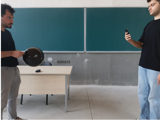
Şekil 1. RT-60 Reverberasyon süresi ölçümü Şekil 2. RT-60 Reverberasyon süresi ölçümü-2
