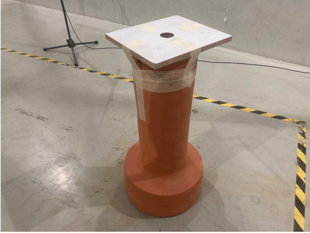
Şekil 5. Rezonatör boynundaki giriş çapı küçültülerek yapılan ölçümler esnasında çınlama odası içerisindeki numune fotoğrafı
