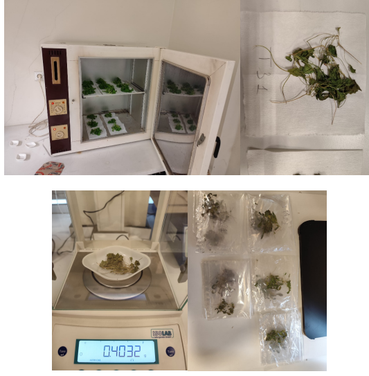
Şekil 4. Bitki örneklerinin etüvde kurutulması ve kuru ağırlığın belirlenmesi
