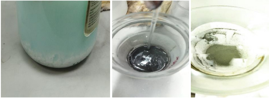
Şekil 9. Gümüş klorür çökeltisi (solda) gümüş oksit çökeltisi (ortada) yıkama sonrası gümüş (sağda)
