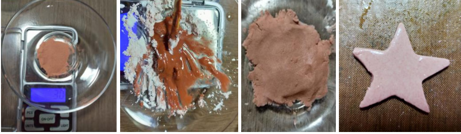
Şekil 4. Mikron bakır tozu ile yapılan ilk denemelerde fazla konulan organik bağlayıcıların malzemelerin sinterleşmeye olan olumsuz etkisi.
