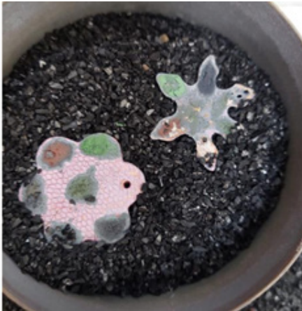
Şekil 17. Aktif karbondaki pişirimi gerçekleştiren metal killer.
