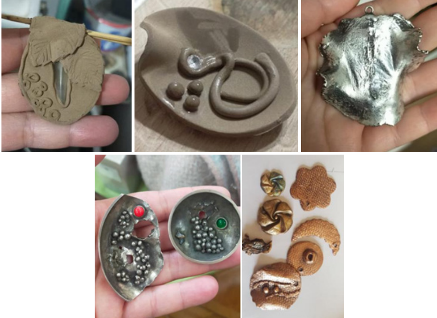
Şekil 5. Metal tozu oranının yüzde 1 ile 4 ü arasında kullandığımız organik bağlayıcılar (arap zıncı ve metilen selülöz) ile yapılan ve olumlu sonuçlar elde edilen metal kil üretimleri.
