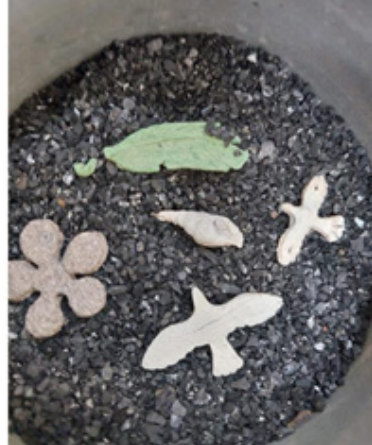
Şekil 17. Aktif karbondaki pişirimi gerçekleştiren metal killer.
