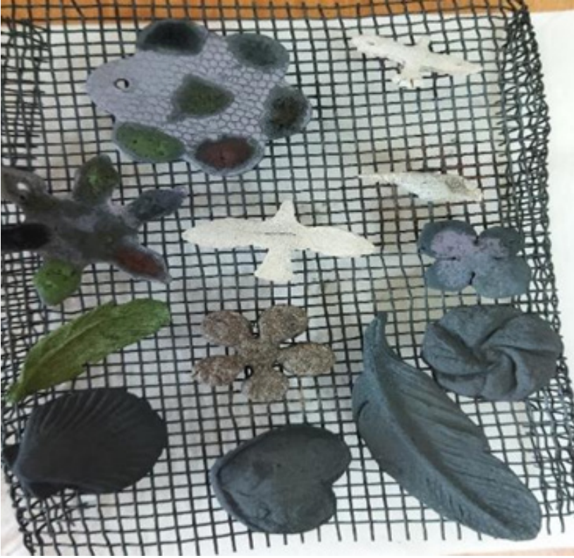
Şekil 16. İlk pişirimi gerçekleştiren metal killer.
