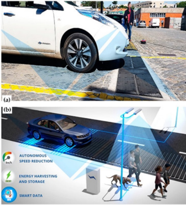
Şekil 16. (a) Pavnext tarafından geliştirilen NEXT-road prototipi, (b) Pavnext Co. Tarafından uygulanacak olana ilk pilot tesis
