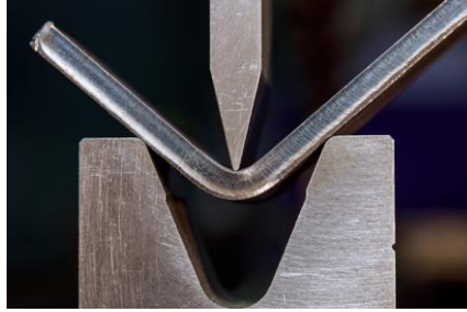
Şekil 5.2. Abkant V büküm prosesinin gösterimi.
