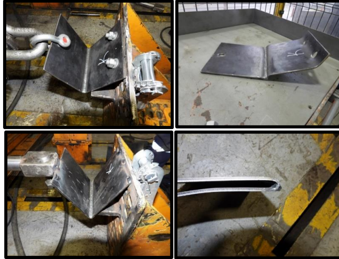
Şekil 5.9. Kaynak Prosesle Üretilmiş “V” Parçasının Basma ve Çekme Deneyi Sonucu
