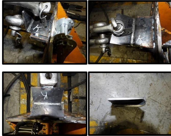
Şekil 5.13. Kaynaklı Prosesle Üretilmiş “L” Parçasının Çekme ve Basma Deneyi Sonucu
