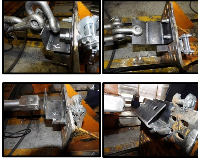
Şekil 5.17. Kaynaklı Prosesle Üretilmiş “U” Parçanın Çekme ve Basma Deneyi Sonucu
