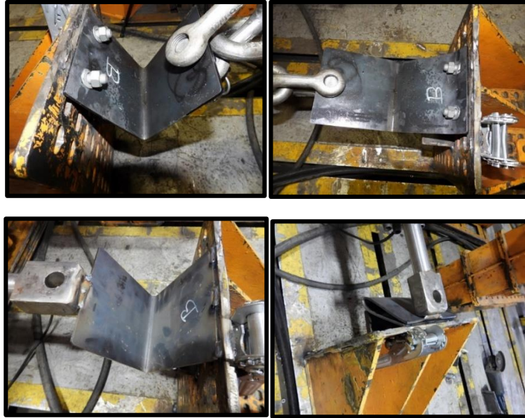
Şekil 5.7. Büküm Prosesle Üretilmiş “V” Parçanın Basma ve Çekme Deneyi Sonucu
